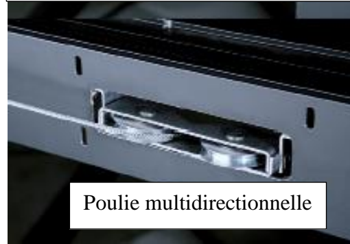
Poulie multidirectionnelle Sous carter et gaine de protection
